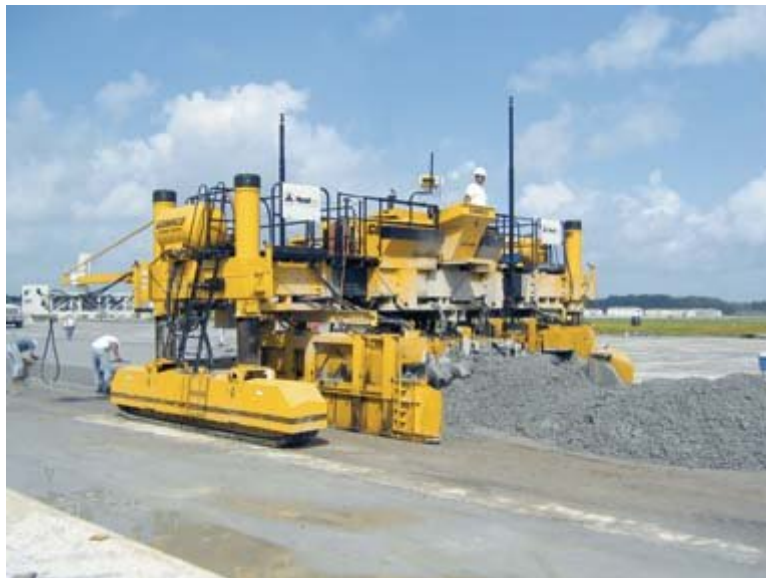
Obrázek 1 – Finišer nové generace GOMACO GHP-2800 při pokládce přistávací plochy
