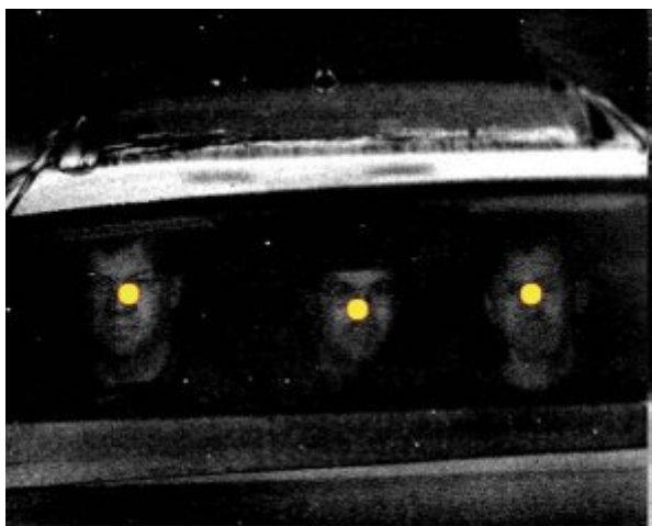
Obrázek 1 – Na tomto obrázku, pořízeném jednotkou Cyclops – blízkým infračerveným detekčním systémem, jsou vidět 3 cestující ve vozidle Peugeot
