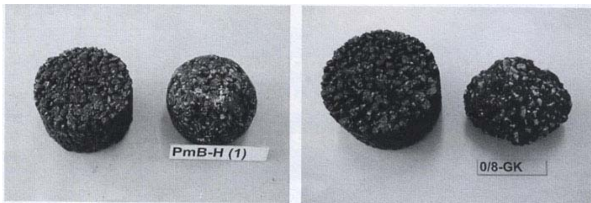
Obrázek 2 – Marshallovo zkušební těleso před a po zatížení
