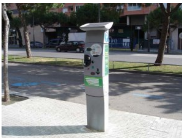
Obrázek 1 - Terminál Parkeon Stelio umožňující platbu pomocí mobilního telefonu ve městě Tarragona
