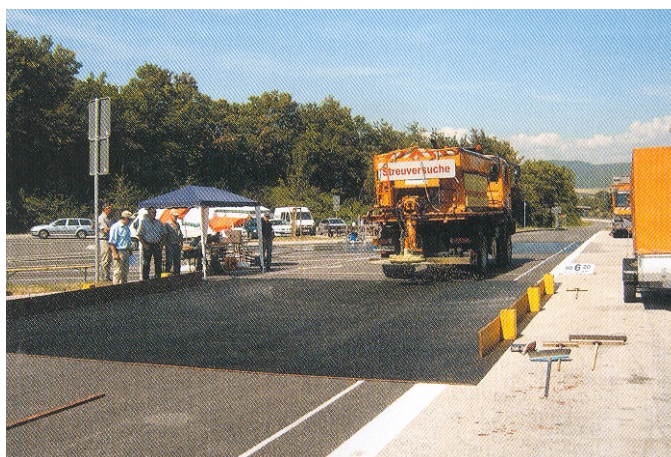
Obrázek 3 – Posypová zkouška s jedoucím vozidlem na zkušebním úseku
