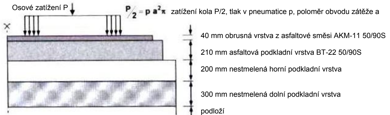
Obrázek 1 – Model struktury zvolené konstrukce vozovky
