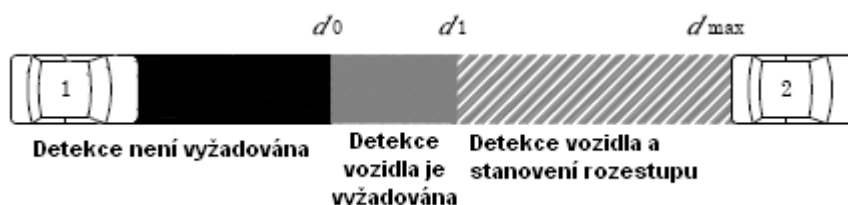
Obrázek 3 – Rozsah detekce (1 – předmětné vozidlo, 2 – cílové vozidlo)
